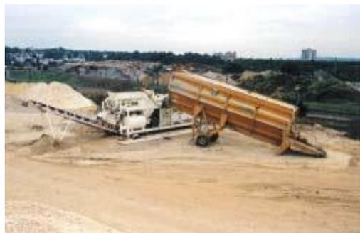
**Photo 92 - Installation semi mobile SMS / MATRIF pour le traitement des déblais de chantier (source : Matériaux de construction)**
