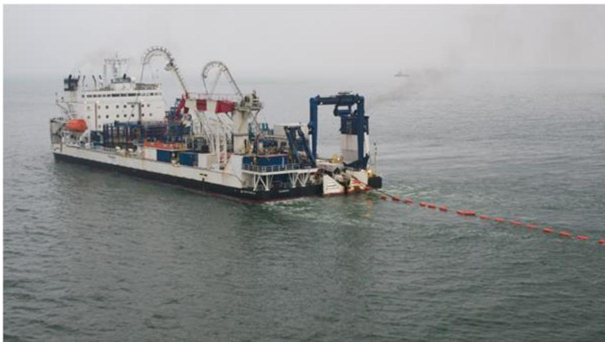
**Photo 1 - Navire câblé déployant un câble sous-marin à distance d'un point d'atterrissage (RTE, 2019)**
