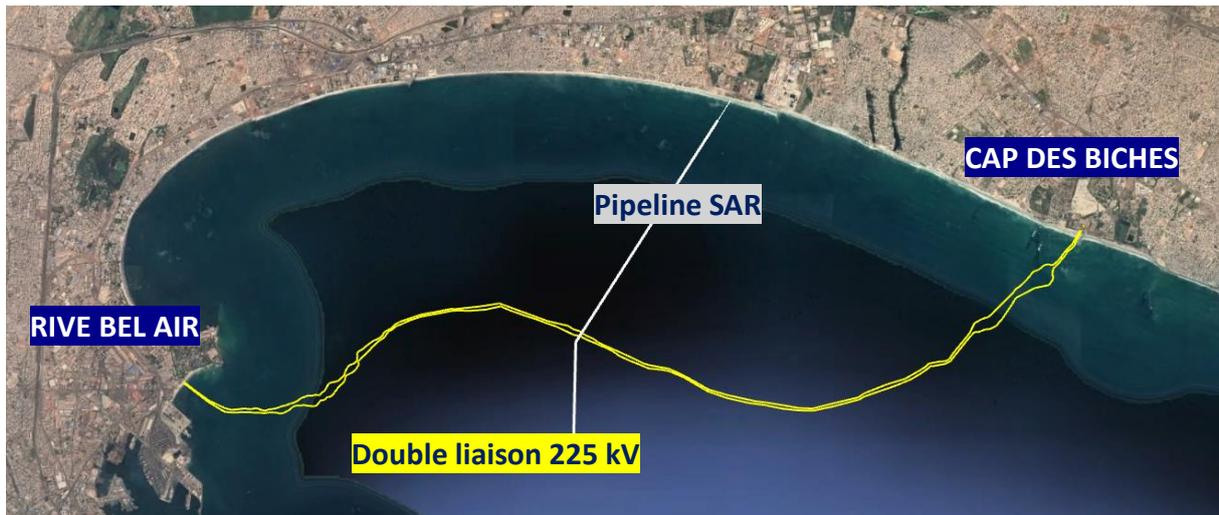
**Figure 127 - Croisement du trace sous-marin avec le pipeline de la SAR**
