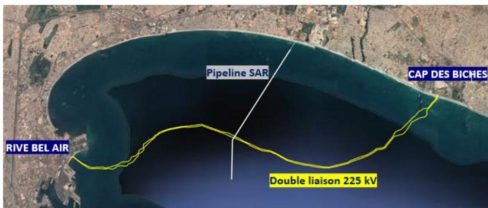
Conformément à l'approche standard de l'industrie pour le croisement de pipelines et de câbles le croisement est réalisé au-dessus de l'actif existant.
