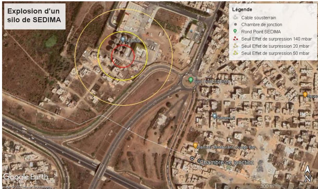
Figure 126 - Représentation de l'explosion de silo de la SEDIMA
