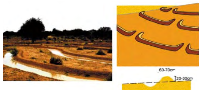
Photos 5 : Diguettes en terre sur courbes de niveau
