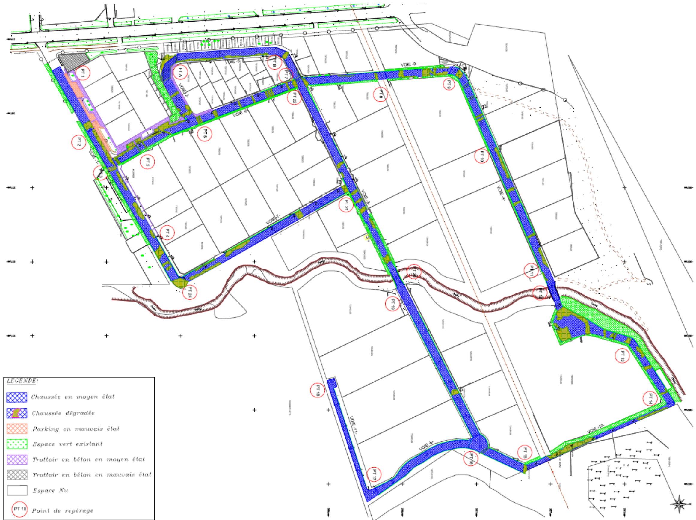
Figure 43 : Représentation graphique du diagnostic de l'état initial de la voirie au niveau de la zone industrielle de Bouznika
