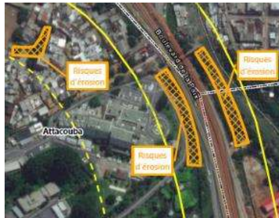
Figure 161 : Zone à risques d'érosion à proximité du Groupe Scolaire ADJAME SANTE 1 et 2 et du Quartier Général de l'ONU de Côte d'Ivoire (d)
